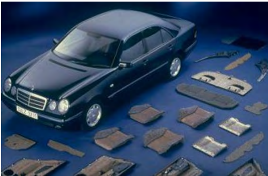
Figuur 8. Agrovezelcomposieten in de Mercedes S-klasse. (Foto: DaimlerChrysler)
